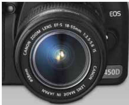
▲ 镜头上的 3.5~5.6，表示广角端的最大光圈为 f/3.5 ，远望端的最大光圈为 f/5.6
