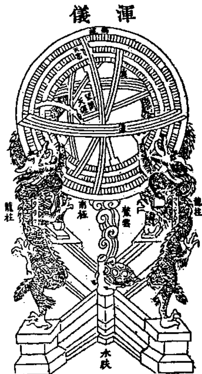
苏颂《新仪象法要》的构造图（左）和浑仪图（右）。
